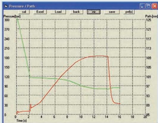
PFC (PressureForceControl) ermöglicht es, druckempfindliche Werkstoffe wie beispielsweise Fiberglas zu verpressen. Resultierend ist eine dauerhafte, stabile und starke Verbindung. Dieses System basiert auf der Regelbarkeit des verwendeten Pressdruckes, um auf die jeweiligen Werkstoffeigenschaften einzugehen. So wird die höchste Qualität Ihrer Produkte sichergestellt – und das ohne Schrauben, Kleben oder Schweißen!
