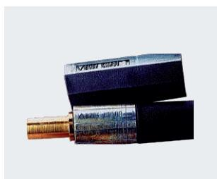
Kennzeichnen und Pressen in einem Arbeitsgang gemäß DIN 20066, EN 853, EN 854, EN 856, EN 857.
